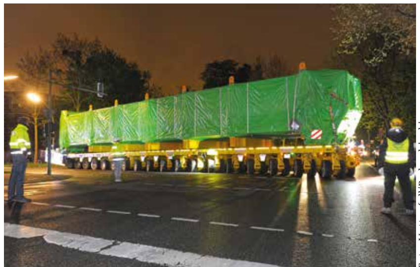
Transport von Kraftwerksmodulen (194 t) mit 1x 18 Achsen
