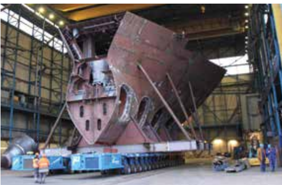
Transport einer Schiffssektion (280 t) mit 2x 18 Achsen
