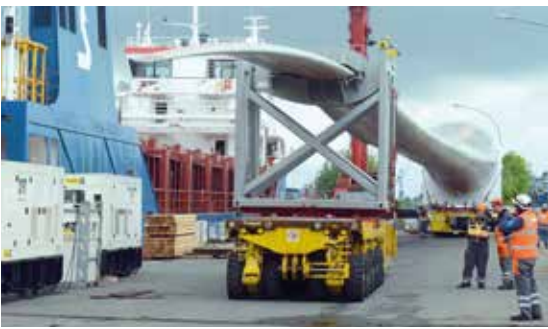
Transport eines Prototypen für ein Rotorblatt (83,5 m Länge, 34 t Gewicht) mit 2x 6 Achsen
