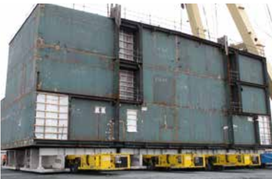
Transport einer 1.200 t schweren Offshore Topside-Sektion mit 4x 12 Achsen
